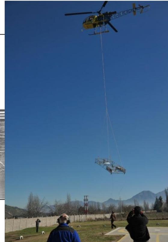
La antena es una estructura de aluminio de 6 x 4 x 1 m, con un peso de 400 kg colgando a 20 m del helicóptero
