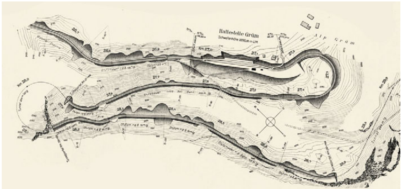
Bernina line > Alignment at Alp Grüm. Plan taken from: E. BOSSHARD: Die Berninabahn , Zurich 1912 ( Schweizerische Bauzeitung , offprint).
