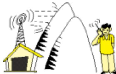
Радио FM имеет охват вещания только в зоне прямой видимости от антенны до получателя сигнала. На коротком расстоянии оно обеспечивает более четкий и качественный сигнал, чем радио АМ, но это преимущество теряется в холмистой или гористой местности. АМ обеспечивает более однородный охват большой территории, но в ночное время могут возникать помехи, вызванные работой отдаленных станций, и эта радиостанция является более дорогостоящей.
