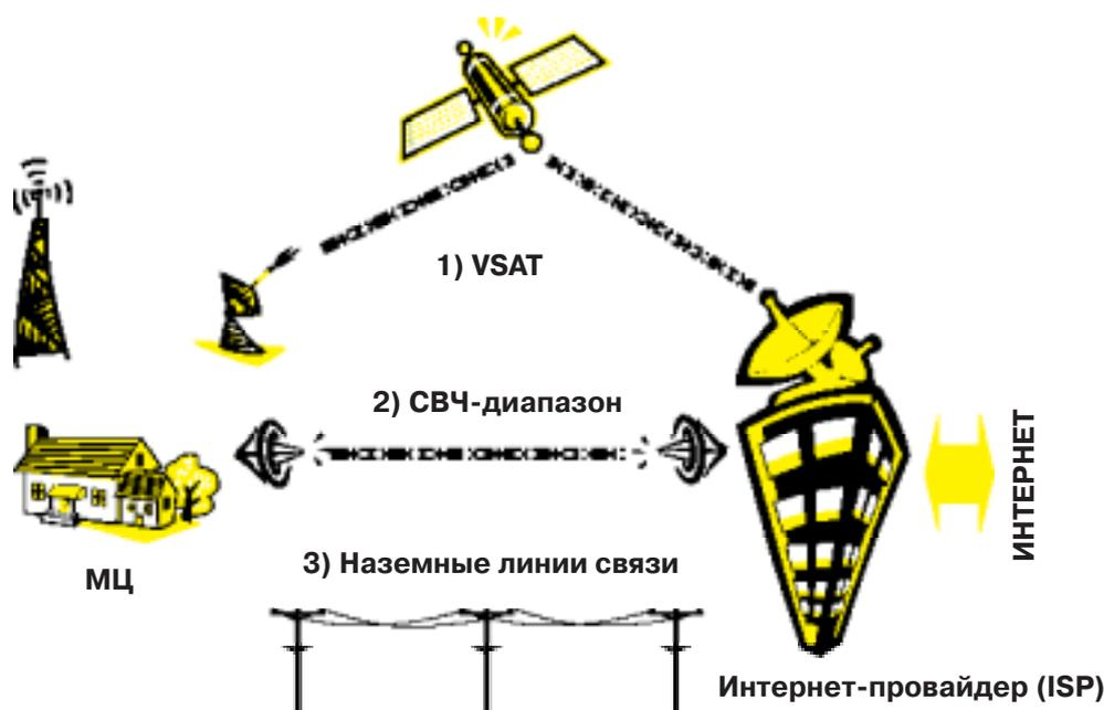
**Подключение с использованием наземных линий связи.** Установление модемной связи с местным Интернет-провайдером часто будет первым шагом, если в вашей местности имеется хорошо функционирующая система телефонной связи и телефонный модем пропускной способностью 56 Кбит/с (килобит в секунду). Это обеспечит подключение вашего центра и позволит обмениваться по сети с другими ОМЦ советами и опытом работы.
