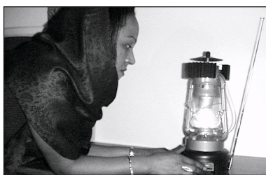
La lamp Lufo, composée de l'association d'un récepteur radio et une lampe
