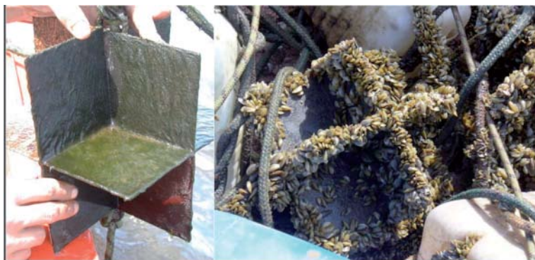
Figura 5. Paneles de incrustación al inicio (izquierda) y al finalizar (derecha), el período de incubación en Embalses Palmar.
