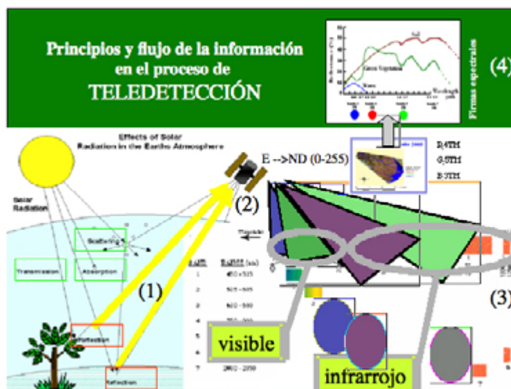
Figura 2. (1-2) Conversión de la energía resultante del proceso de reflexión a un formato digital (ND), (3) segregación de la información, en función de la longitud de onda (4); posterior confección de las firmas espectrales vinculadas a las coberturas para una posterior interpretación.
