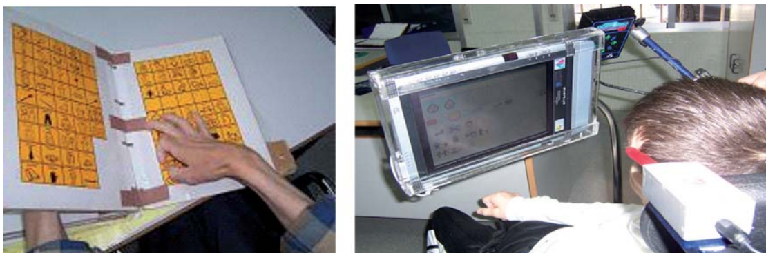
Figura 4.9. A la izquierda acceso a las láminas del tablero de comunicación de forma tradicional y a la derecha a través de un dispositivo móvil (Tablet PC) con un sistema de barrido la síntesis de voz.
