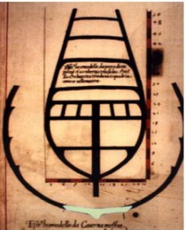
Plano de reconstrução do casco de uma galera do Museu Municipal de Aveiro, baseado no plano de construção do Museu Municipal de Aveiro, baseado no plano de Manuel Fernandes, 17 de maio de 1620 (Arquivo Histórico Ultramarino).
