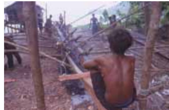
การเบิกกราบเรือที่ต้องทำด้วยความระมัดระวัง
