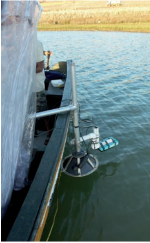
▲ © MMRG. Un échosondeur Knudsen 320BP et son récepteur externe modifié par le Pr Lloyd Huff (Center for Coastal and Ocean Mapping, Université du New Hampshire), avant son immersion durant la Morocco Maritime Survey, Maroc. L'échosondeur, ainsi que son unité GPS, furent montés sur un petit bateau de pêche et utilisés pour mesurer la profondeur des paléo-canaux et du lit actuel de l'oued Loukkos dans le cadre des recherches menées sur le site de l'ancien port de pêche de Lixus, Maroc (Octobre 2010).
