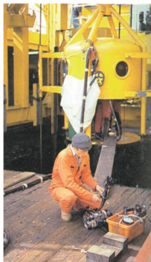
▲ © AAO. Cloche de plongée ouverte durant un projet de recherche dans le secteur néerlandais de la mer du Nord. Les objectifs du projet et sa localisation définissent le type de plongée requis. Plonger en haute mer avec une cloche depuis un bateau à positionnement dynamique nécessite d'autres procédures qu'un projet en eaux peu profondes. Néanmoins, les mêmes principes s'appliquent et, dans tous les cas, un responsable de plongée doit diriger les opérations.
