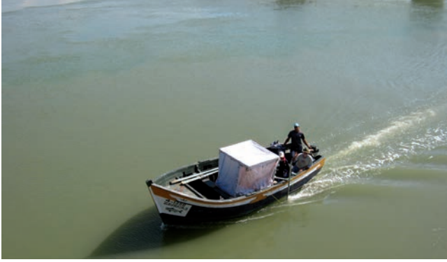
◀ © MMRG. Un échosondeur Knudsen 320 BP utilisé par-dessus le flanc bâbord du Zouhair 3, un petit bateau de pêche, dans l'oued Loukkos durant les investigations menées dans le cadre de la Morocco Maritime Survey sur le site de l'ancien port de Lixus, Maroc. Un cockpit construit avec des tuyaux en PVC et de bâches en plastique abritait les appareils électroniques servant à l'étude. Sur cette photo figurent le géologue marin Hasnae Jirari (gauche), le capitaine du bateau Younes Raazi (centre) et l'hydrographe Lloyd Huff (droite).
