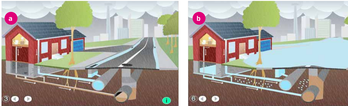
Figura 12. Esquema del sistema de alcantarillado separado: a) operación normal cuando los flujos pluviales se mantienen dentro de la capacidad de diseño; b) operación cuando se sobrecarga el sistema de alcantarillado pluvial (D'Andrea, 2011)
