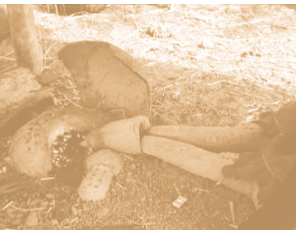
Le foyer, l'autel de la forge, la pince et la buse des soufflets des forgerons Moose
