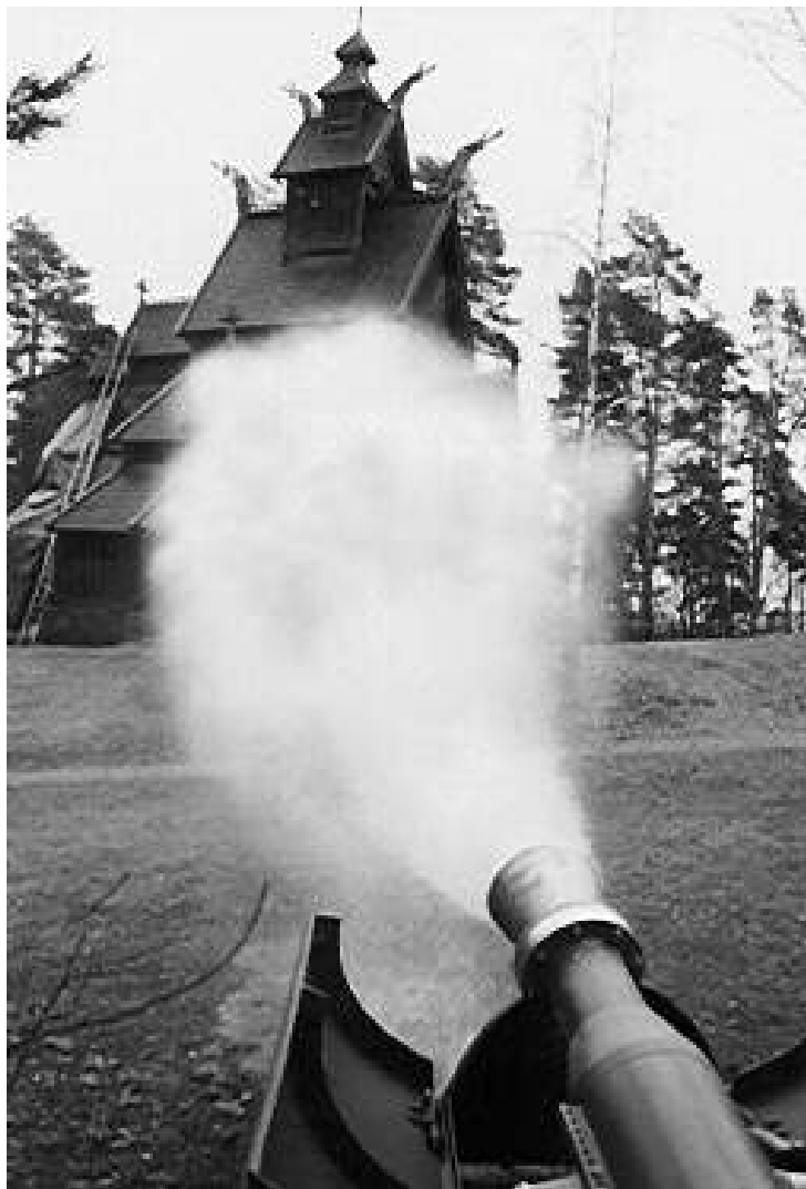
Prueba de un cañón de agua (extintor contra incendio de agua pulverizada) Foto del autor
