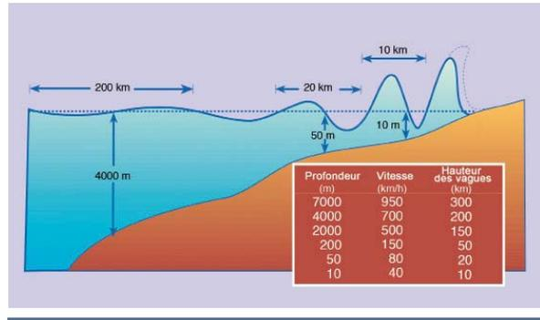
Hauteur des vagues et profondeur de l'eau. En haute mer, un tsunami n'a souvent qu'une dizaine de centimètres de haut, mais sa hauteur croît rapidement en eau peu profonde. Même dans les eaux les plus profondes, l'énergie de l'onde du tsunami va de la surface jusqu'au fond. Quand le tsunami arrive à la côte, l'énergie se concentre sur une distance bien plus faible, provoquant des vagues destructrices et potentiellement mortelles
