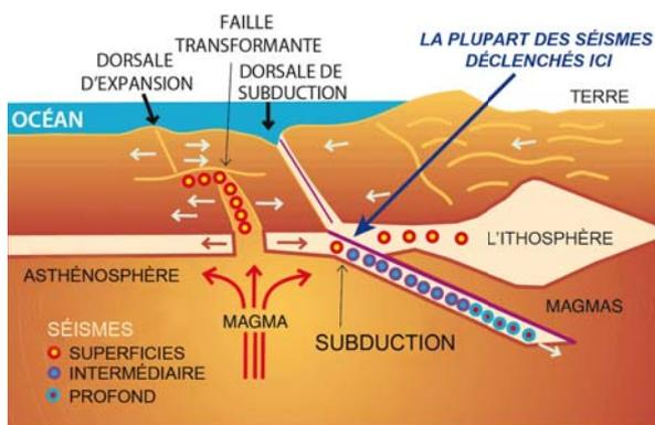
La plupart des tsunamis sont provoqués par de forts séismes de compression qui se produisent à faible profondeur dans les zones de subduction. Des séismes superficiels se produisent également le long des dorsales d'expansion, mais ils ne sont pas suffisamment forts pour générer des tsunamis. De forts séismes superficiels peuvent aussi se produire le long des failles transformantes mais ils n'engendrent qu'un faible déplacement vertical et ne déclenchent pas de tsunamis.
