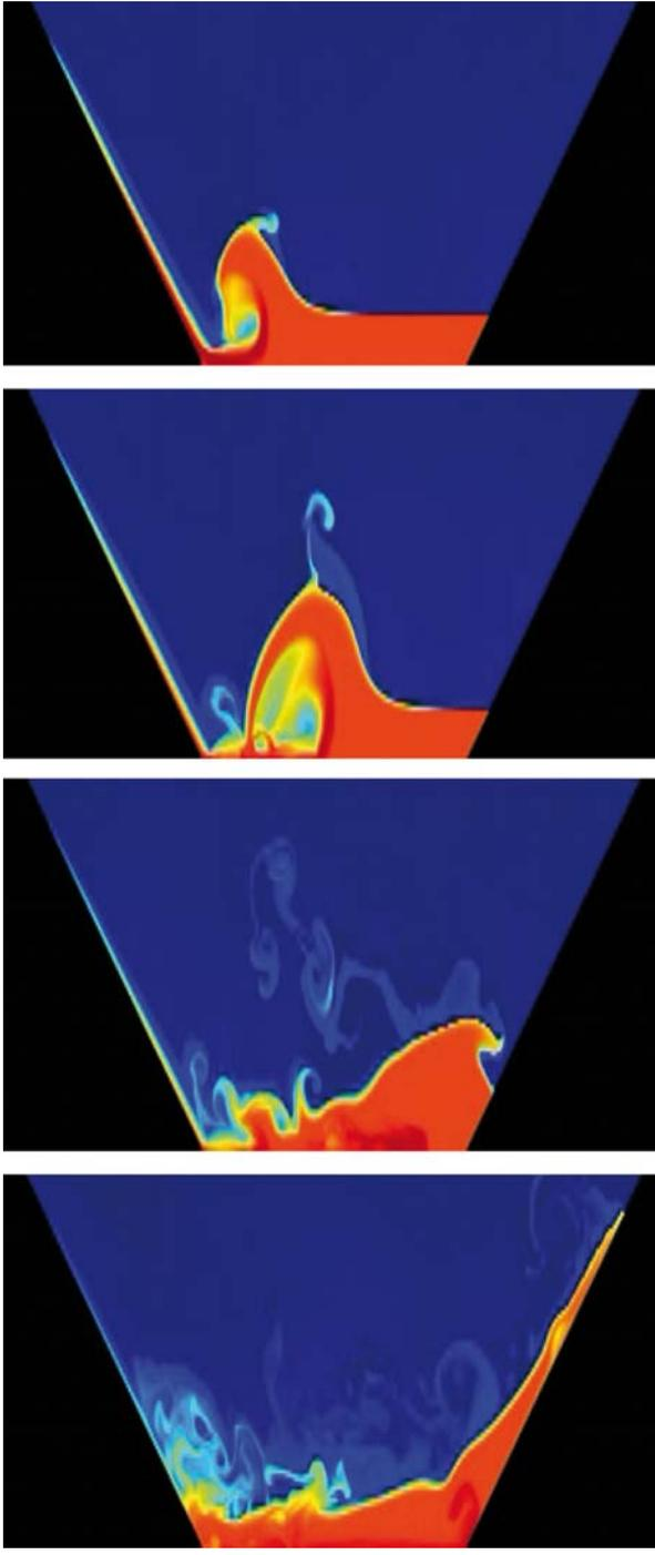
Modèle numérique complexe calculé pour le tsunami local qui s'est produit à Lituya Bay (Alaska) en 1958, à la suite d'un glissement de terrain, et qui a causé le run-up le plus élevé jamais enregistré (525 m). Cette modélisation complexe reproduit de façon très détaillée les remous et gerbes d'eau de deuxième ordre mis en évidence par des expériences en laboratoire. Avec l'autorisation de Galen Gislser, Los Alamos National Laboratory
