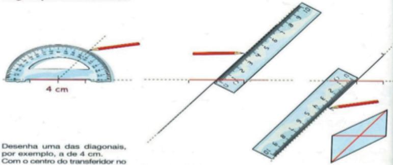
Desenha uma das diagonais, por exemplo, a de 4 cm. Com o centro do transferidor no ponto médio desse segmento, marca um ângulo de 55° e traça a recta correspondente.
