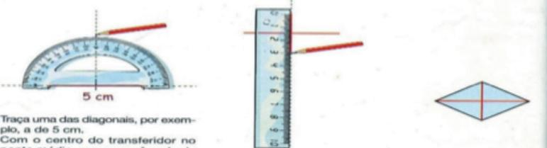
Traça uma das diagonais, por exemplo, a de 5 cm. Com o centro do transferidor no ponto médio, marca um ângulo de 90° (as diagonais do losango são perpendiculares) e desenha a recta correspondente.
