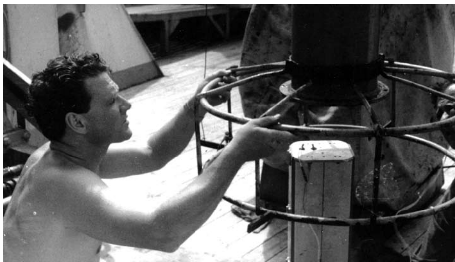
K. N. Fedorov (secrétaire de la COI de 1963 à 1969) à bord d'un navire de recherche en 1972, vérifiant la sonde CTD (conductivité-température-profondeur).
