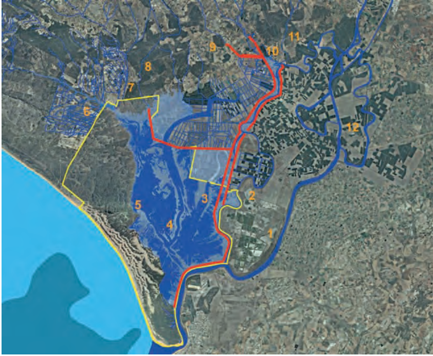
Figura 3. Red hidrográfica transformada de la marisma; en una primera etapa, se produjeron los encauzamientos del río Guadalquivir, así como las modificaciones hidrológicas para la agricultura (1947-1977); en la segunda etapa, se procuró la regeneración hídrica de la marisma (1982-1987), aunque sus actuaciones también causaron importantes impactos en Doñana, debido a la ausencia tanto del conocimiento científico preciso como de una visión holística de todo el sistema. 1. Río Guadalquivir; 2. Brazo de la Torre; 3. Caño Travieso; 4. Caño Guadimar; 5. Madre de las Marismas; 6. Arroyo de la Rocina; 7. Arroyo del Partido; 8. Arroyo Cañada Mayor; 9. Arroyo de la Cigüeña; 10. Río Guadimar; 11. Arroyo de Majaberraque; 12. Brazo del Este.
