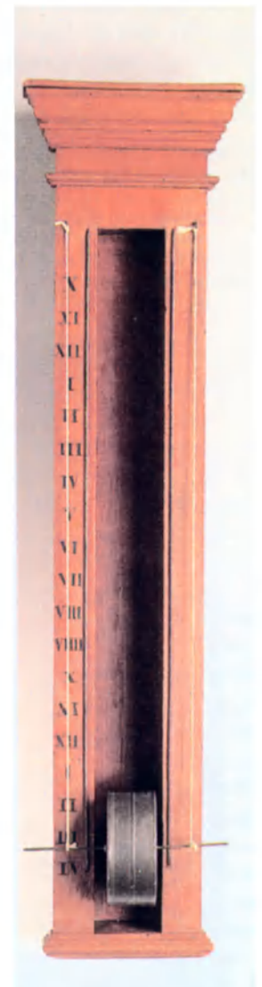
Clepsydre française à tambour, début du 19 e siècle. En s'écoulant lentement, l'eau contenue dans le tambour fait tourner celui-ci. Grâce aux deux cordelettes enroulées autour de son axe, le tambour, en tournant, descend en face des graduations indiquées sur les montants.
