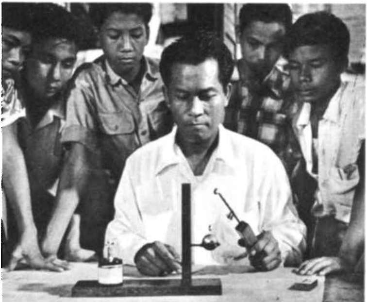
Chauffée à blanc sur une bouteille de colle transformée en brûleur, la balle ne peut plus passer à travers l'anneau. Mais refroidie, elle reprendra son volume antérieur et tombera.
