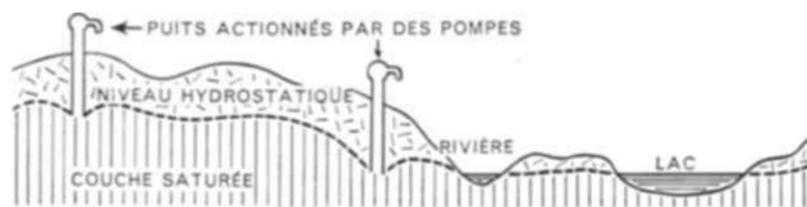
COUPE VERTICALE D'UN TERRAIN montrant le niveau hydrostatique par rapport à la surface de la terre. Les puits, dont la profondeur doit toujours dépasser le niveau hydrostatique supérieur, abaissent ce niveau dans leur voisinage immédiat. La hauteur de la nappe souterraine, en un point donné, varie suivant les précipitations atmosphériques et les quantités d'eau puisées. Elle atteint généralement son niveau le plus bas en automne.
