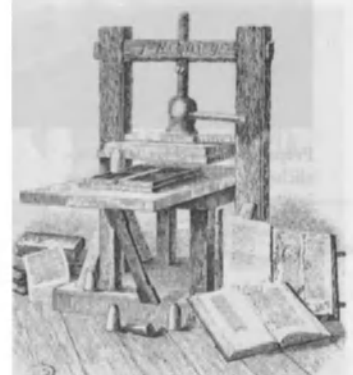
8. La presse de Gutenberg, reconstituée à Leipzig au 19 e siècle. Elle est pourvue de deux plateaux plans : l'un fixe, en bas, qu'on appelle le marbre, et l'autre mobile, en haut, la platine. La forme, c'est-à-dire l'assemblage des caractères constituant le texte, était serrée dans un châssis métallique, encreée, couverte d'une feuille de papier, puis pressée entre les deux surfaces.
