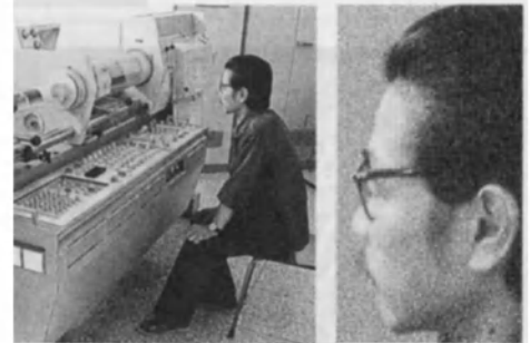
28. Le scanner (ci-contre) est un appareil électronique qu'on utilise pour le traitement analytique des éléments d'illustration, dits documents, destinés à la reproduction imprimée. Le document est fixé sur un cylindre et reproduit sous forme d'un ensemble de points. A droite, points de simili agrandis.
