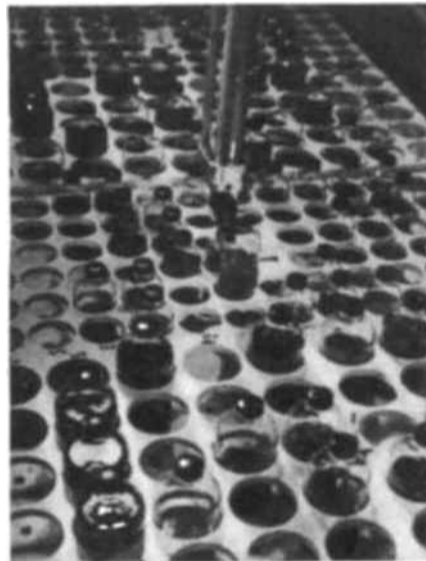
La plupart des isotopes sont conservés dans des solutions liquides. Des techniciens, protégés par un mur épais, opèrent au moyen d'un miroir (les rayons radioactifs frappent latéralement et non verticalement). Les bocaux sont remplis et enlevés grâce à un ingénieux système qui exécute...
