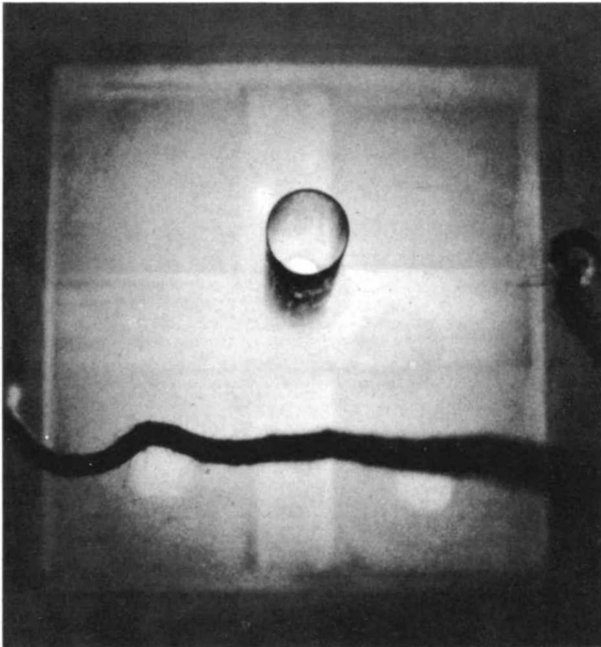
UN RÉCIPIENT CONTENANT DU COBALT RADIOACTIF et placé dans une cuve remplie d'eau a pu être photographié grâce à la seule luminosité de l'eau "éclairée" par les puissants rayons gamma émis par le cobalt. (L'ombre noire est une partie de la corde qui sert à tenir la cuve). (Photo Brookhaven Nat. Lab.)
