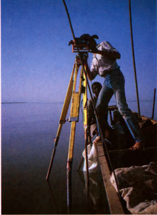
Instalación de un punto geodésico sumergido.
