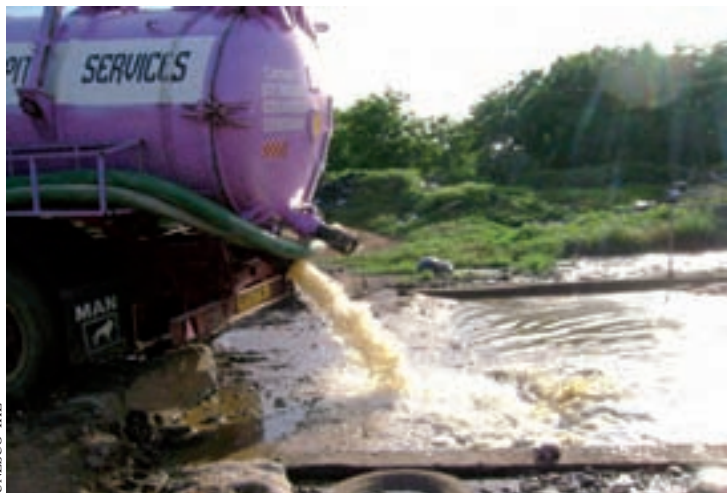
Sebuah trak sedang membuang air kumbahan ke dalam longgokkan baja dan stesen penimbunan tanah di Thesie. Air yang sampai di sini tidak akan menerima apa-apa rawatan lagi.
