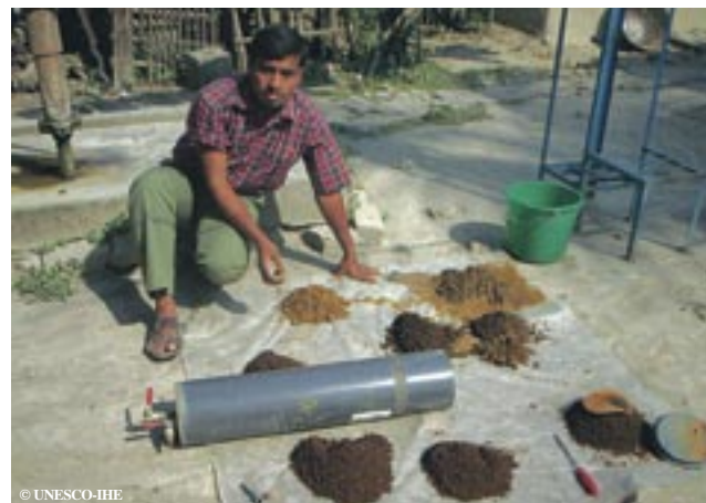
Inspección de un filtro familiar luego de un año de operación continua. La arena cubierta de óxido de hierro toma una coloración carmelita oscura cuando está usado. El óxido de hierro es conocido también bajo el nombre de orin
