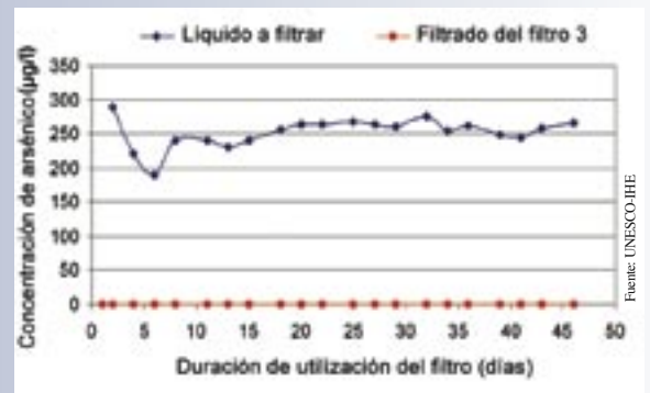
La eficacia del filtro antiarsénico a escala industrial, 45 días después de su puesta a prueba, en 2004, en Mako, Hungría. El «Líquido a filtrar» es un agua subterránea que proviene de un pozo donde la concentración de arsénico es extremadamente alta.
