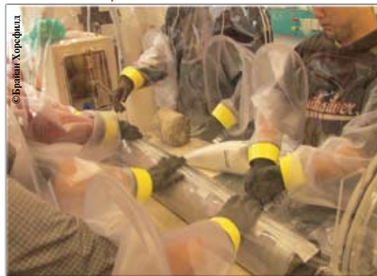
Чтобы извлечь микробиологические формы жизни из бурового ядра, требуются стерильные условия. Другие меры предосторожности необходимо соблюдать во время бурения, чтобы не занести микробы с земной поверхности в буровую скважину.
