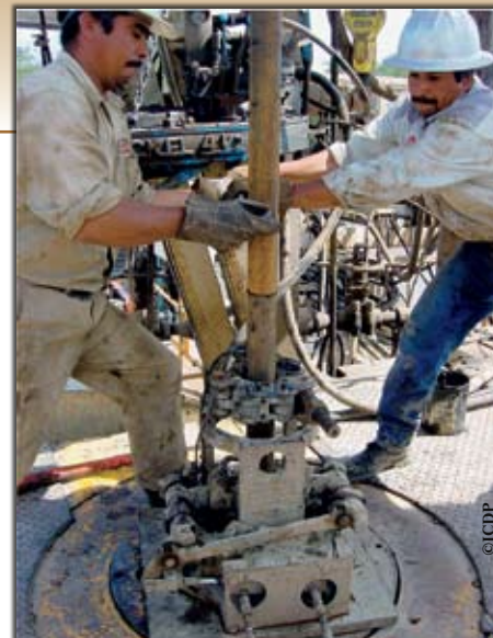
Рабочие на буровой вышке, стыкующие бурильные колонны во время бурения в районе кратера Чиксулуб на полуострове Юкатан в Мексике.
