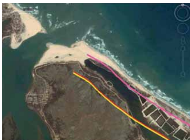
Modelo de predicción del cambio de costa para 2100 en la entrada Tu Hien en Vietnam, donde la lluvia se prevé que aumente. Efecto de la línea púrpura: efecto Bruun solo, línea amarilla: efecto Bruun más llenado de la cuenca; efecto de línea roja: efecto Bruun, llenado de la cuenca más los efectos de las lluvias y escorrentía combinados.
