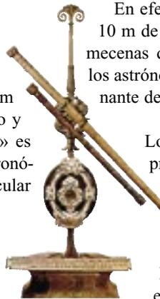
*El telescopio de Galileo consiste en un simple tubo de 50 cm de largo y 1 cm de diámetro*
