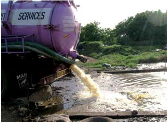
Un camion décharge des eaux usées dans la station de Thesie débordant de compost et de déchets enfouis. L'eau qui y parvient ne subira aucun autre traitement
