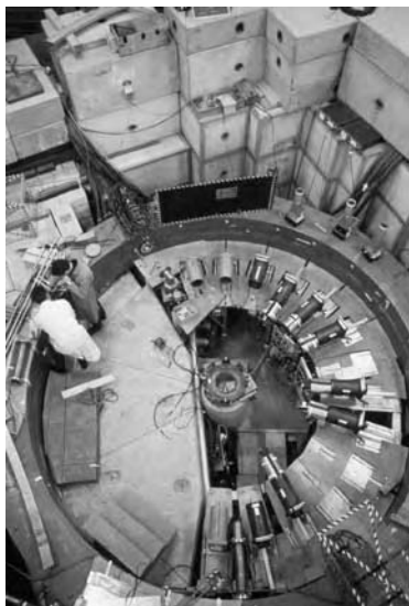
Illustration 71 Accélérateur de particules nucléaires au Conseil européen pour la recherche nucléaire (Cern), près de Genève en Suisse. Cet appareil utilise les champs électriques pour propulser des particules chargées électriquement à de grandes vitesses et hauts niveaux d'énergie (photo Marc Garanger).
