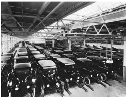
Illustration 128 La ligne d'assemblage automobile, introduite par l'industriel américain Henry Ford en 1913, a révolutionné les techniques de travail et donné naissance à la production de masse (photo Bettmann/Corbis).
