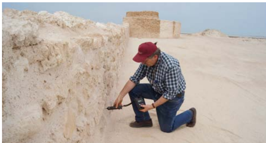
Fig. 6 : Test et échantillonnage des matériaux de construction par le Dr Robert Sobott, Université de Leipzig.
