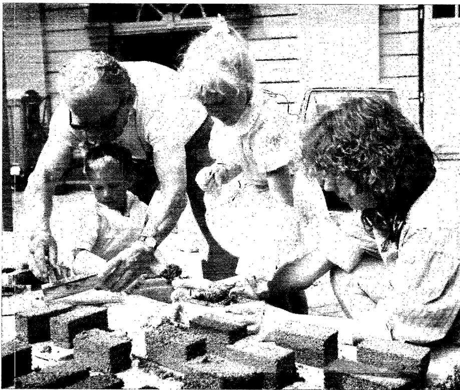
34 Fabrication manuelle de blocs d'aggloméré de ponce par des enfants.
