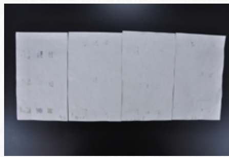
模拟全色实验 不同浓度胶矾水全色渗透情况（样品背面）
