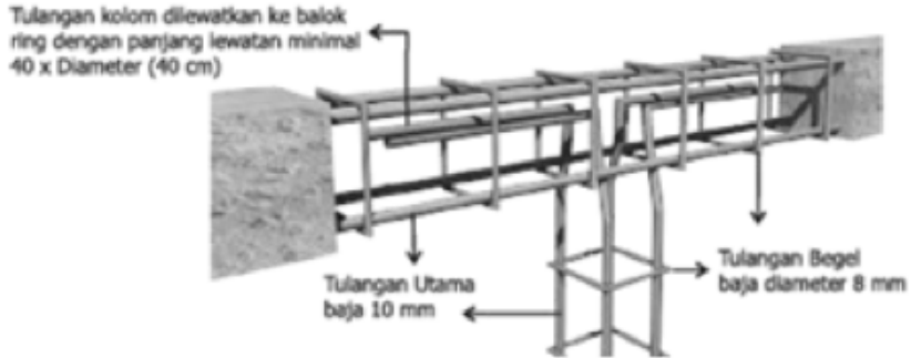
Gambar 48. Hubungan Anatar Kolom dengan Balok Keliling/ Ring
