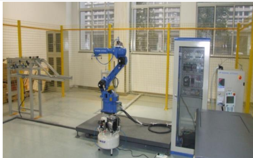
工业机器人搬运系统
