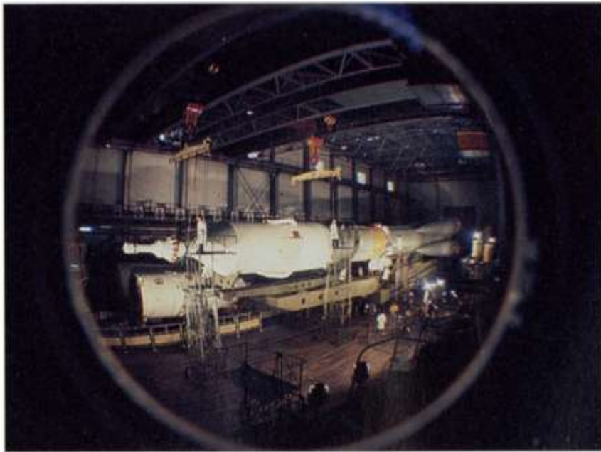
Un vaisseau spatial soviétique Soyuz est fixé à son lanceur, au cosmodrome de Baïkonour.
