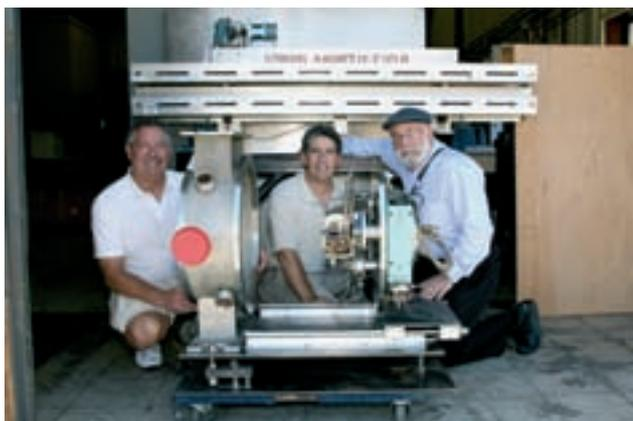
Équipement envoyé par le SLAC à SESAME. Au fond de la photo, l'onduleur à aimants permanents de 2m de PEP. Devant, le monochromateur rayons X, à double crystal de type Brown-Hower
