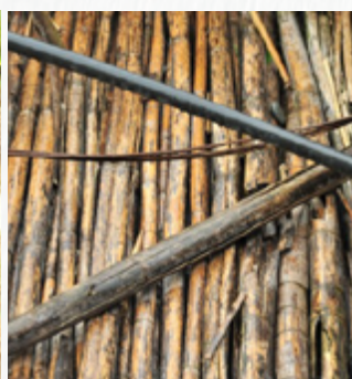
图二：沤制后的竹料捞出切断
