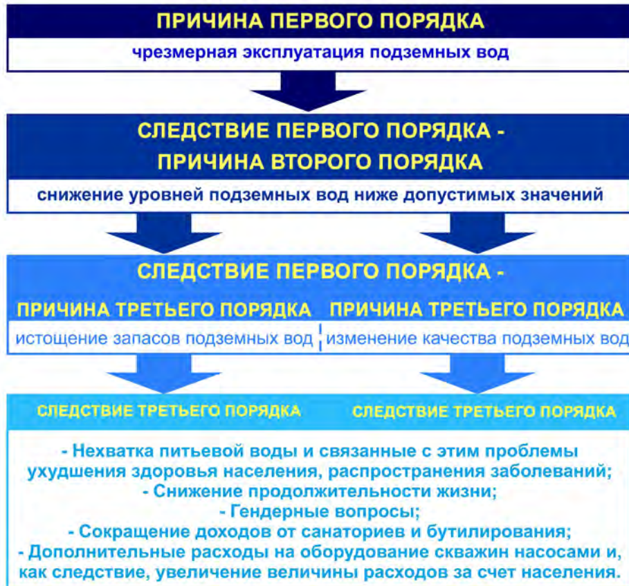
Рис. 7.2 | Схема причинно-следственной связи по проблемам истощения запасов подземных вод Приташкентского ТГВГ и потенциального изменения и ухудшения их качества
