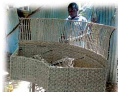
Les fibres séchées des jacinthes d'eau servent à fabriquer des meubles, comme ce siège arrière d'autocar avec dossier.
