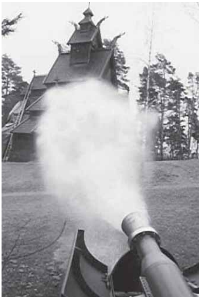
Испытание уникального водомета (средство пожаротушения водяным туманом). Фото автора.
