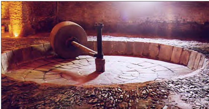
"Tahona" o molino primitivo de agave. Refugio de San José del Refugio.
