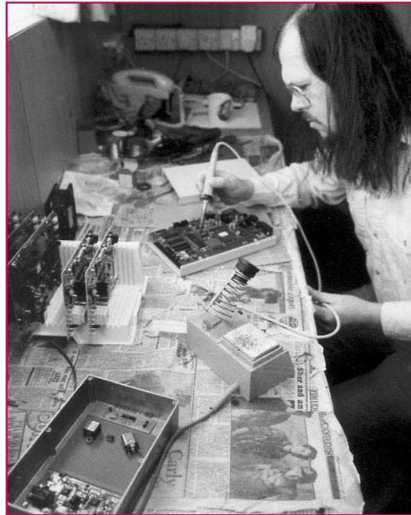
Fixation de circuits sur des émetteurs FM de 20 W. à Brixham (Royaume-Uni).
