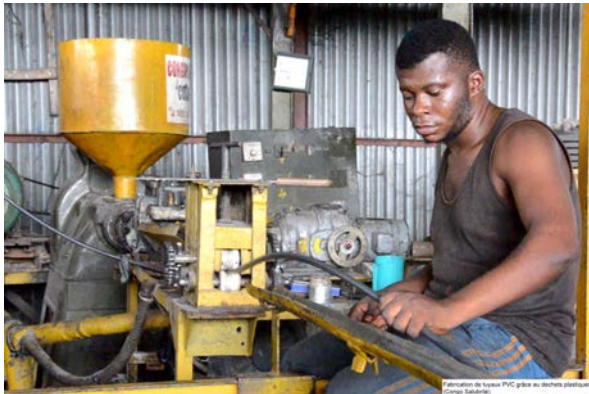
Fabrication de lattes PVC grises au déchets plastiques George Sabeloko
