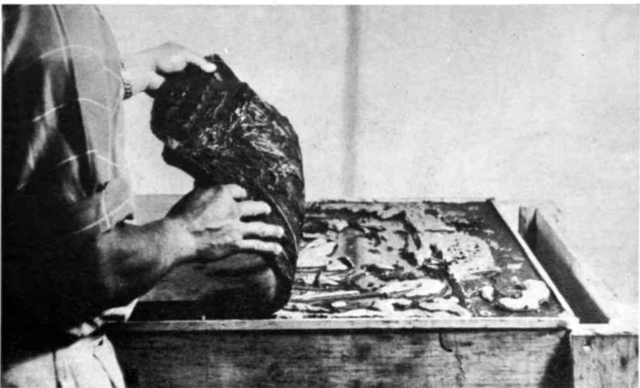
Une fois la gravure terminée, un mélange de colle et de glycérine est versé sur la cire. Le cliché final (voici comment on l'enlève du moule) sert directement à l'impression des affiches. Il suffit d'y appliquer une feuille de papier.
