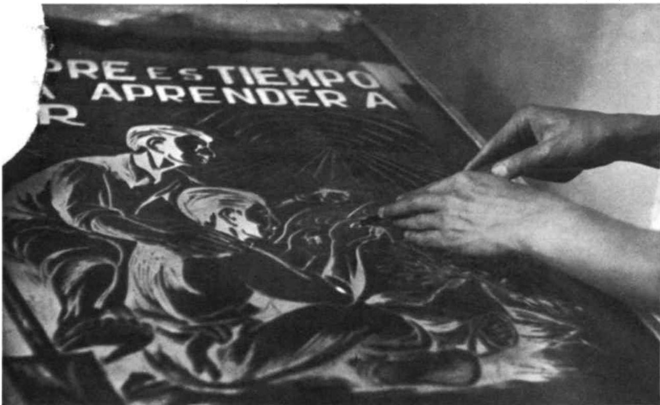
Un artiste grave un dessin dans un mélange de cire de paraffine et de cire d'abeilles étalé sur une plaque de verre. Il creuse jusqu'au verre (voir le graphique de droite). Au besoin on peut calquer sur la cire un croquis tout fait.
