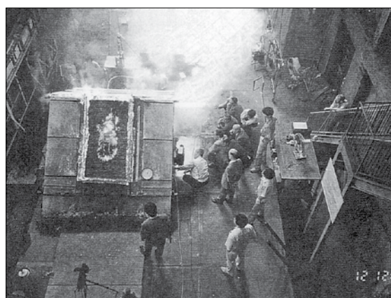
6 消防研究所での茅屋根燃焼実験 Burning experiment
