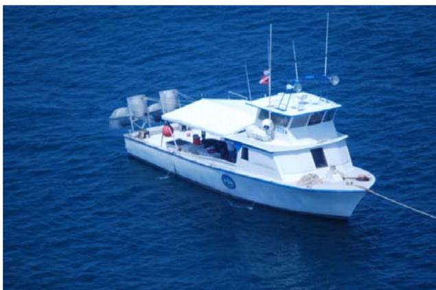
Figura 2.5.a. Arriba: Embarcación Blue Water Rose utilizada por IMDI. En la popa pueden apreciarse los deflectores de hélices utilizados en la excavación del sitio atribuido al pecio *San José*. © UNESCO
