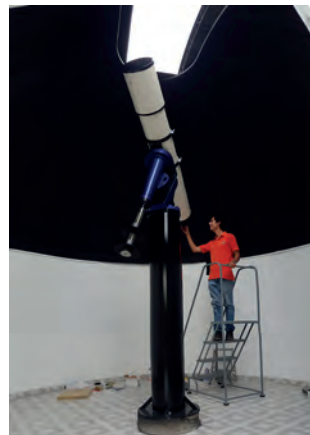
Figura 3. El telescopio refractor apocromático de 10". Se trata del más grande de su tipo en México. © Eduardo Hernández.
