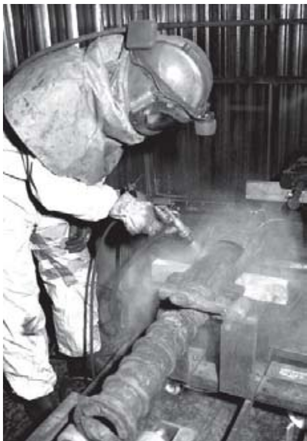
11. Microsistema de limpieza con chorro de arena del cañón de hierro de tipo perrier que data del siglo XVII.
