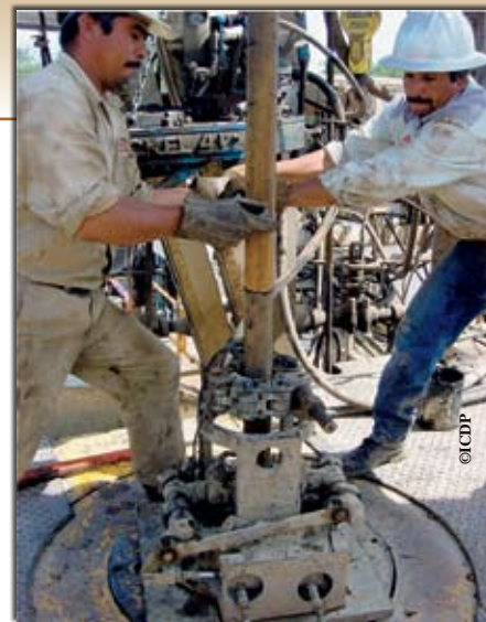
Des ouvriers sondeurs posent un manchon sur la tige de forage durant le projet du cratère de Chicxulub, dans la péninsule mexicaine du Yucatan
